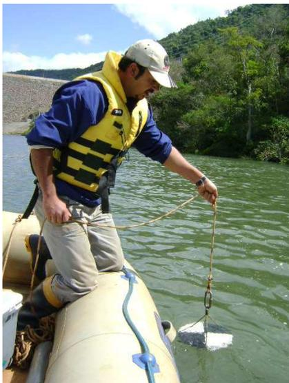
Figura A-III: Medição da transparência da água no TPF (rio Passo Fundo)
