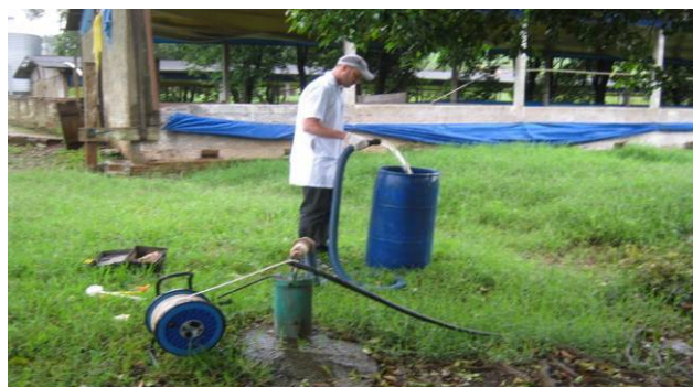
Medição de vazão no poço AGC06
