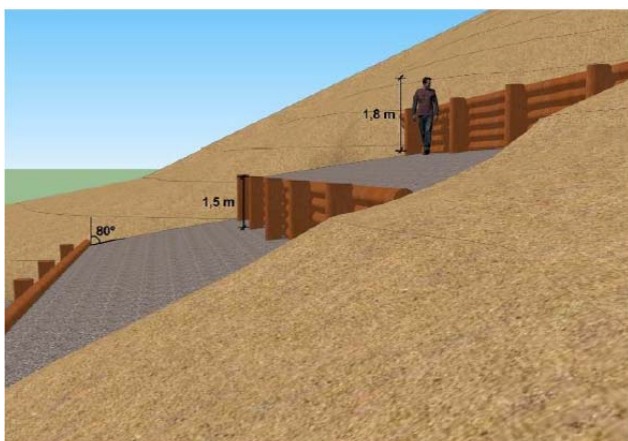
Figura 2.2-II: Detalhe da Angulação das plataformas
