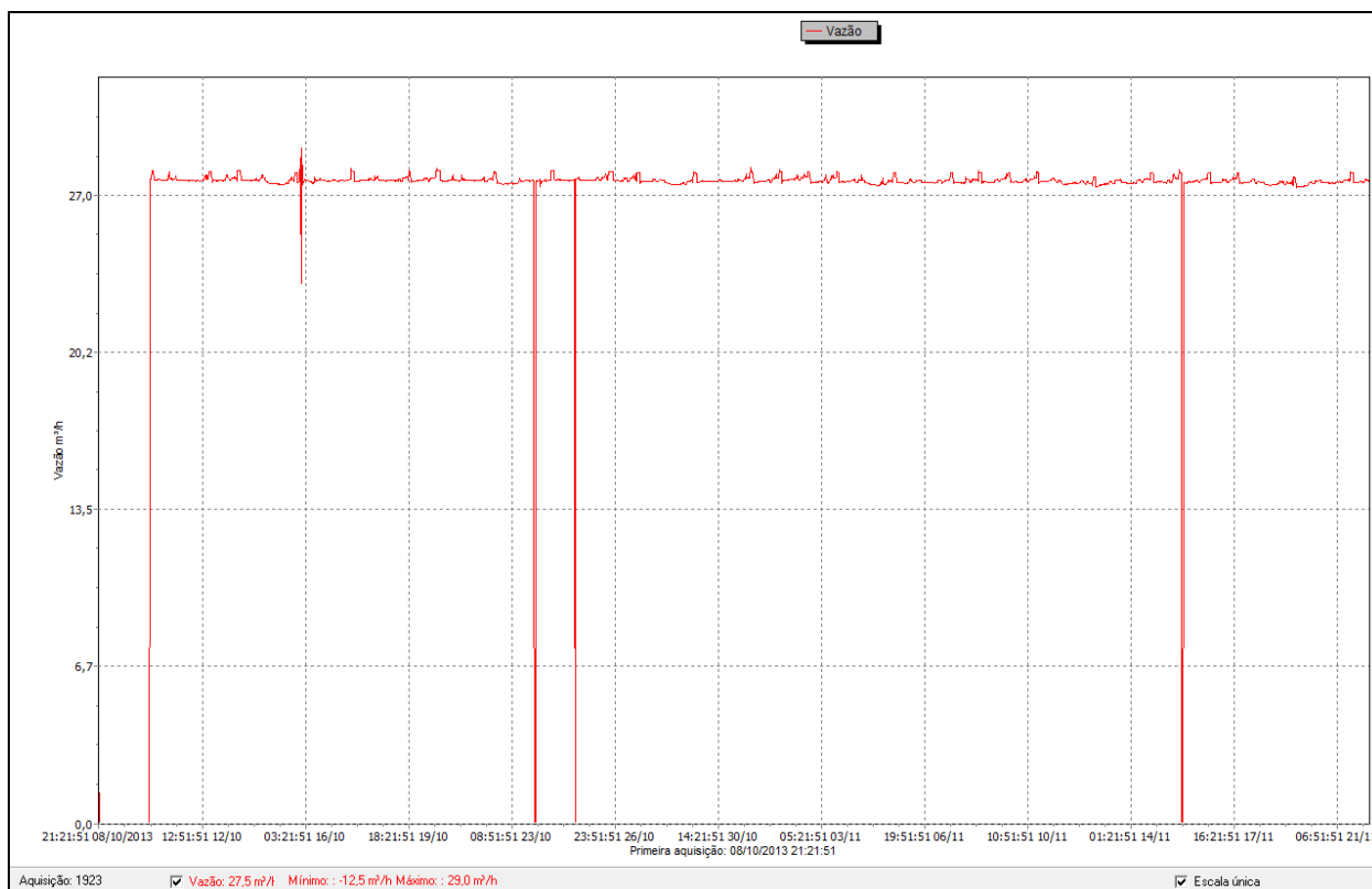
Figura 5-II: Dados de Vazão do poço PMT24
