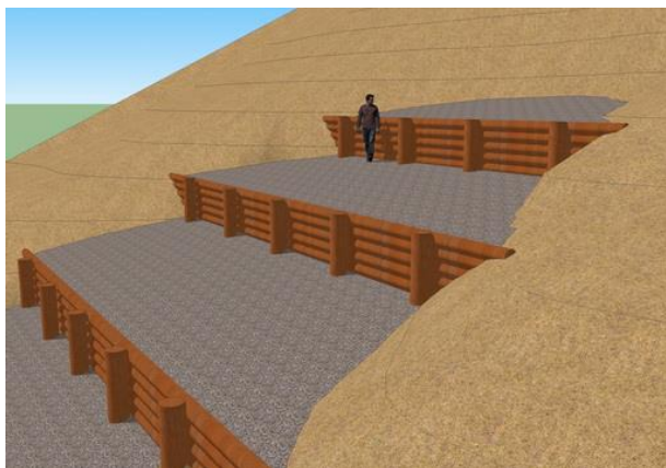
Figura 2.2-I: Detalhe da alternativa da plataforma de contenção
