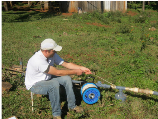
Medição de nível no poço CXS12
