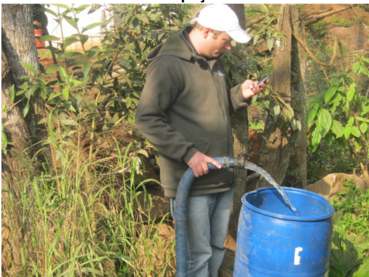
Medição de vazão no poço CXS11
