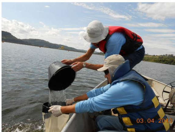
Figura A-V: Amostragem de plânctons no ponto UAc (reservatório, próximo ao barramento), em 03/04/2013.
