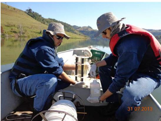
Figura A-V: Coleta de água de profundidade no ponto TLB (Lajeado Bonito).
