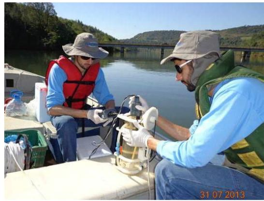
Figura A-II: Determinação de parâmetros em água de profundidade no ponto TLL (Lajeado Leão).
