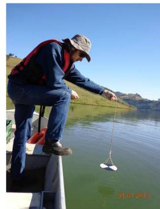
Figura A-VI: Determinação da transparência da água no ponto TLB (Lajeado Bonito).
