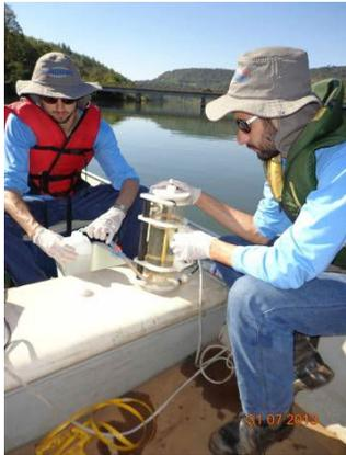
Figura A-I: Coleta de água de profundidade no ponto TLL (Lajeado Leão).
