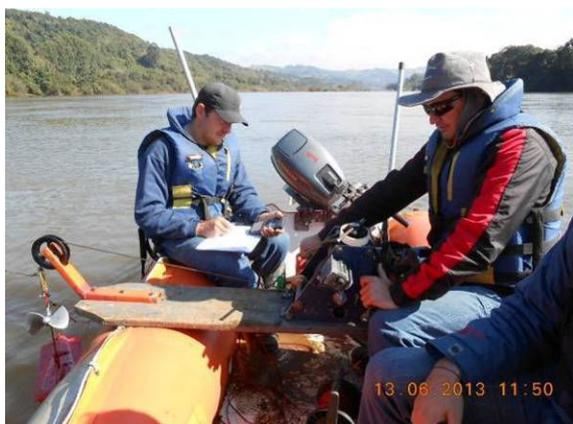
**Medição de descarga líquida (13/06/2013)**
