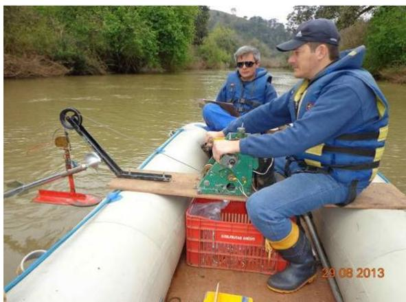
**Medição de descarga líquida (29/08/2013)**
