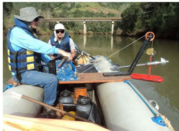
**Medição de descarga líquida (11/07/2013)**
