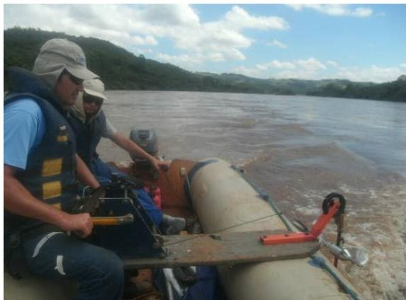
**Medição de descarga líquida (14/03/2013)**
