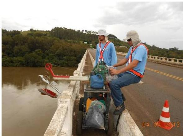
Medição de Descarga líquida (04/04/2013)
