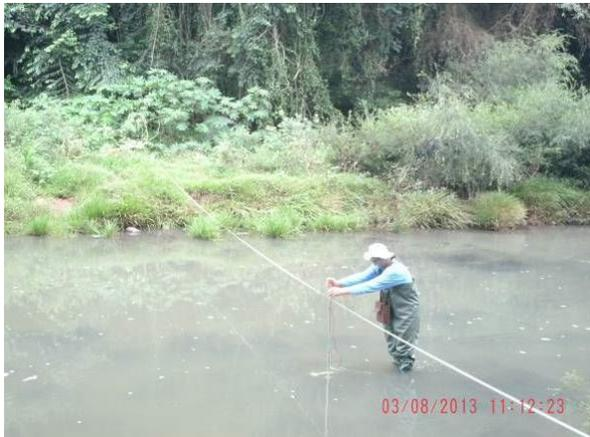
**Medição de descarga líquida (08/03/2013)**
