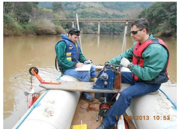
**Medição de descarga líquida (14/06/2013)**
