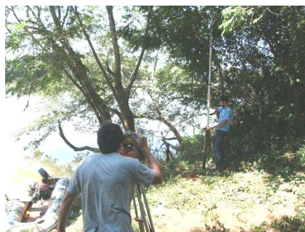
Nivelamento das réguas (21/11/2012)
