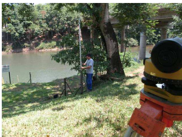
Nivelamento das réguas (22/11/2012)
