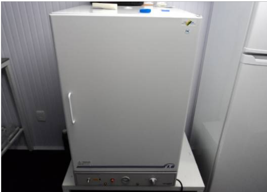
Estufa de esterilização e secagem Adamo/OD mod.6.
