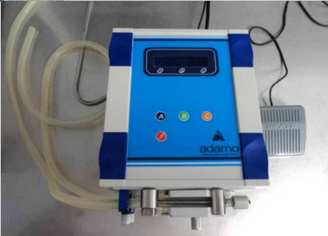
Bomba peristáltica, Adamo mod. DMC 100 220v.
