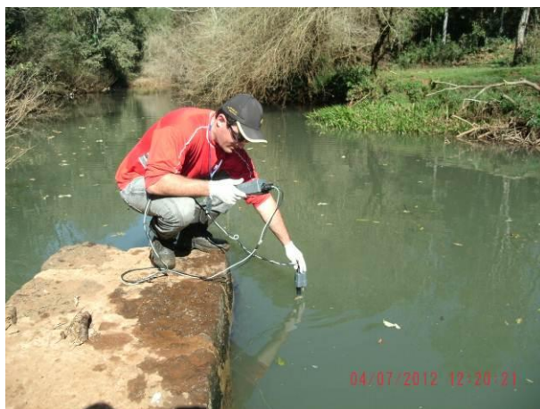
Figura A-III: Determinação de parâmetros físico-químicos na superfície da água no ponto TLB (Tributário Lajeado Bonito), em 04/07/2012.
