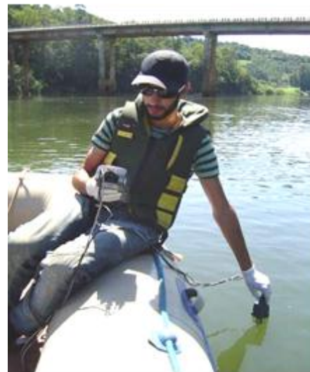
Figura A-IV: Determinação de parâmetros físico-químicos na superfície da água no ponto TJC (Tributário Rio Chapecó), em 08/03/2012.
