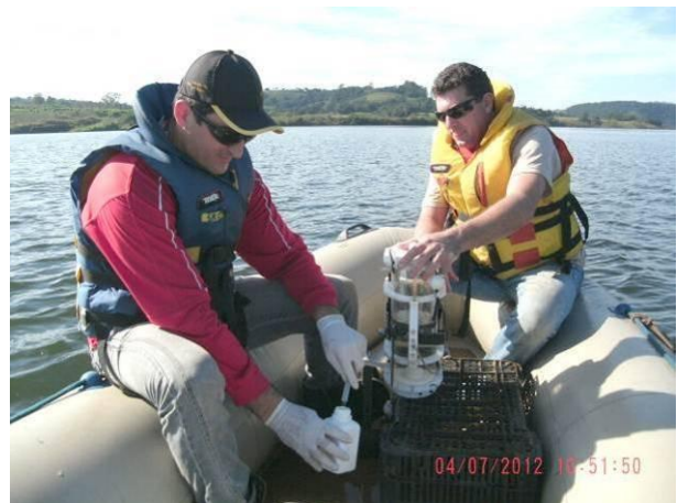
Figura A-XII: Coleta de amostra de água de profundidade no ponto UAc (Reservatório, ponto próximo à barragem, abrange todas as contribuições recebidas pelo rio Uruguai), em 04/07/2012.
