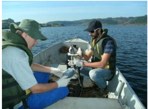
Figura A-VIII: Determinação de perfil da coluna d'água no ponto UAc (Reservatório, ponto próximo à barragem, abrange todas as contribuições recebidas pelo rio Uruguai), em 10/05/2012.
