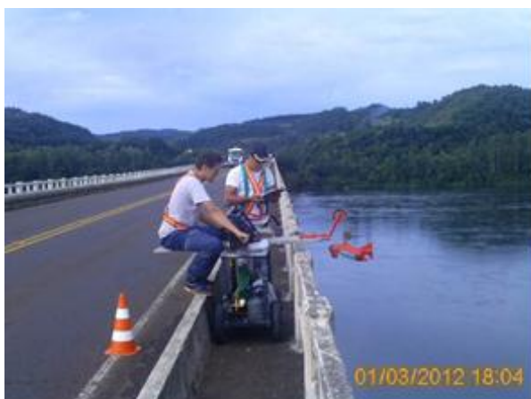
Amostragem de Sedimento em Suspensão (01/03/2012)
