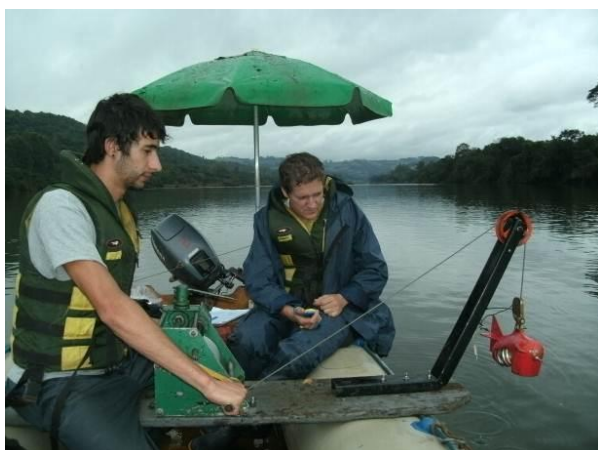
Amostragem de Sedimento em Suspensão (30/05/2012)
