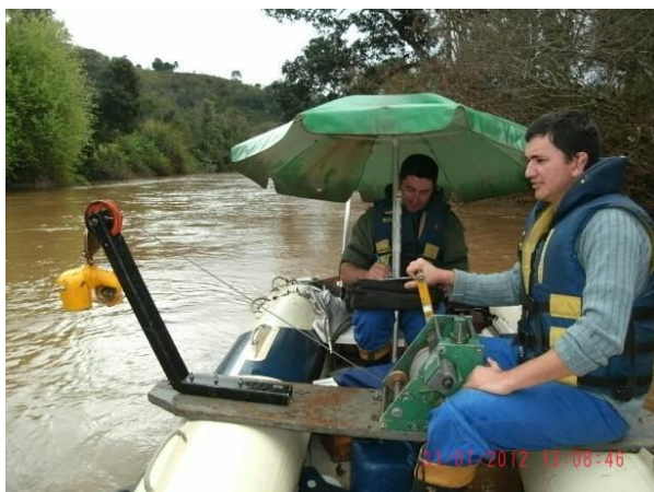
Amostragem de Sedimento em Suspensão (31/07/2012)
