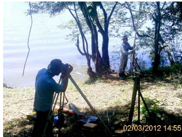
Nivelamento de régua (02/03/2012)
