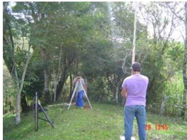
Nivelamento das Réguas Limnimétricas (29/05/2012)
