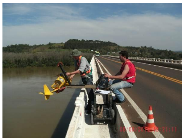
Amostragem de Sedimento em Suspensão (08/08/2012)
