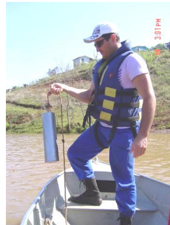
Figura A-IV: Amostragem de sedimento no UCa (Reservatório, ponto abrange contribuição dos tributários formadores da cabeceira do reservatório);
