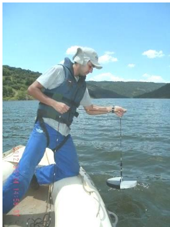
Figura A-XI: Medição da transparência da água no TPF (Reservatório, contribuição do tributário rio Passo Fundo);
