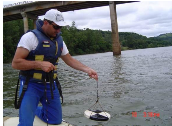
Figura A-II: Determinação da transparência da água no ponto TJC (rio Chapecó), em 10/11/11.
