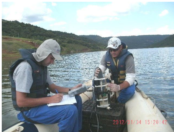
Figura A-III: Determinação de perfil da coluna d'água no ponto UCa (Reservatório, ponto abrange contribuição dos tributários formadores da cabeceira do reservatório) em 05/01/2012.
