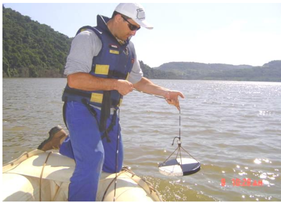
Figura A-VII: Medição da transparência da água no UCe (Reservatório, abrange contribuição dos tributários formadores da parte central do reservatório);
