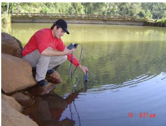
Figura A-III: Medição de parâmetros físico-químicos da água no TL (Reservatório, contribuição do tributário rio Lamberdor);
