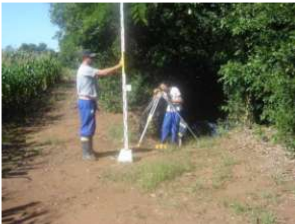
Nivelamento da Seção de Réguas Limnimétricas (26/04/2011)
