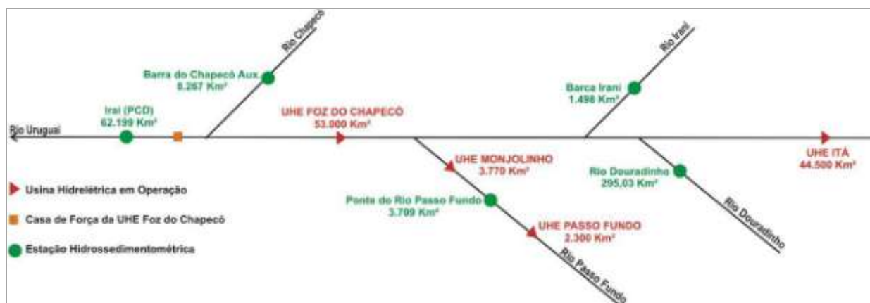
Figura 5-I – Diagrama unifilar topológico da bacia do rio Uruguai na região de influência da UHE Foz do Chapecó
