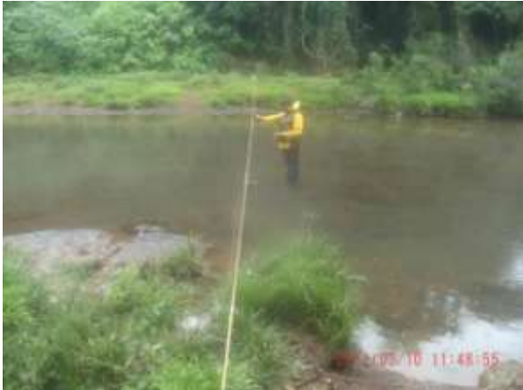
Medição de Vazão (10/03/2011)
