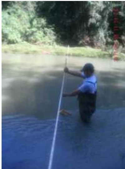
Amostragem de Sedimento em Suspensão (18/05/2011)
