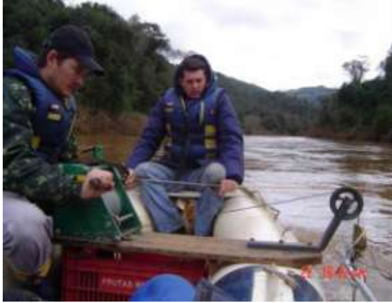
Medição de Vazão (22/07/2011)
