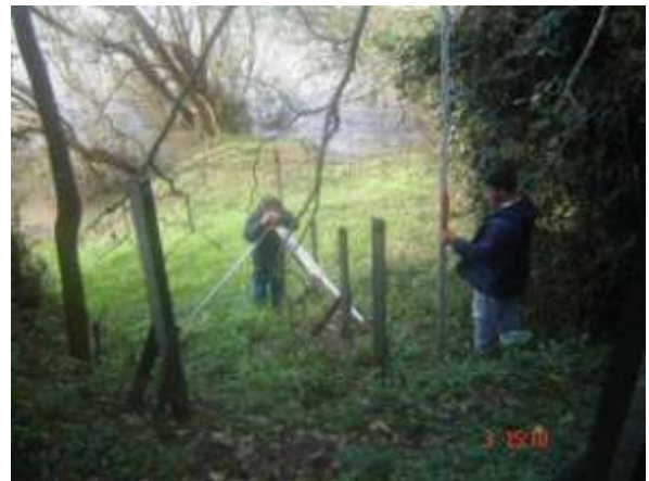
Nivelamento da Seção de Réguas Limnimétricas (03/08/2011)
