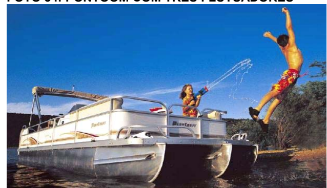
FOTO 34: PONTOOM COM TRÊS FLUTUADORES
