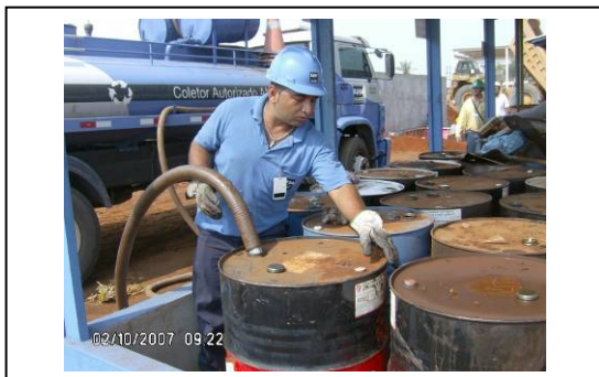
Foto 7. Sucção do óleo queimado armazenado em tambores.
