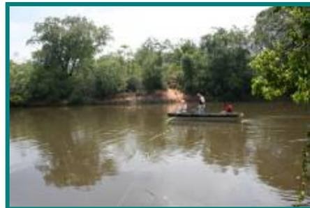
Foto 3.35-6 - Medição de vazão com auxílio do cabo de aço na EHS Faz. Rio Farinha
