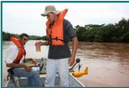
Foto 3.35-5 – Amostragem de sedimentos em suspensão na EHS Goiatins – TO.
