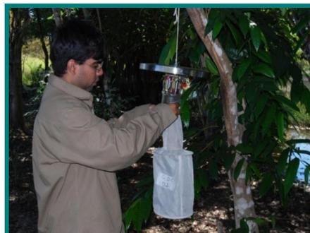
Foto 3.16-2- Coleta de insetos através de armadilha luminosa CDC.
