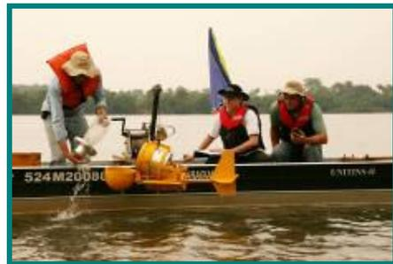
Foto 3.35-4 - Amostragem de sedimentos em suspensão na EHS Tocantinópolis – TO
