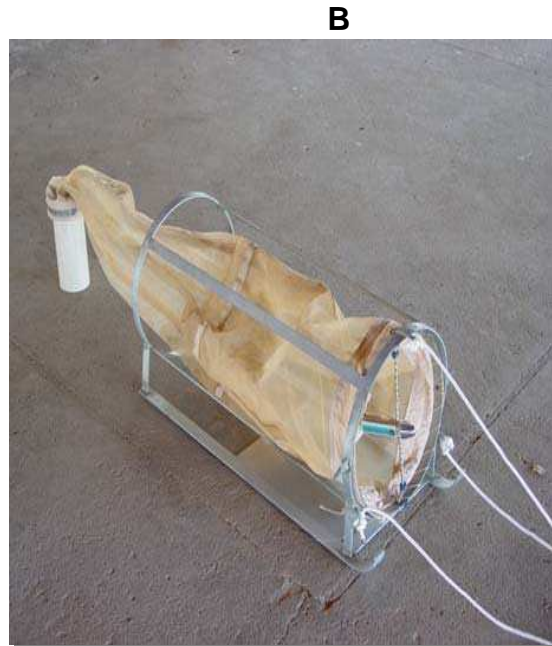
Foto 9.3.1-9 A. Rede cônica-cilíndrica empregada para a amostragem de ictioplâncton em coleta na superfície da água e B rede acoplada ao amostrador de fundo, para coleta sobre o substrato.
