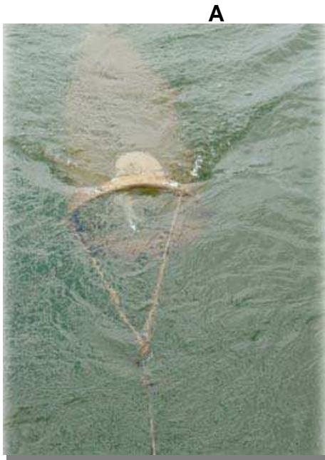
Foto 9.3.1-9 A. Rede cônica-cilíndrica empregada para a amostragem de ictioplâncton em coleta na superfície da água e B rede acoplada ao amostrador de fundo, para coleta sobre o substrato.
