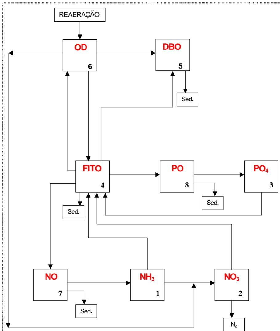
Figura 1.2-1 Estrutura do Módulo EUTRO4 Original
