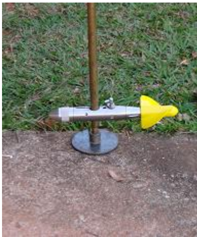
Figura 1. Molinete SEBA utilizado na medição de vazões da primeira campanha de monitoramento.
