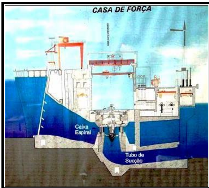
Figura 3.1. - Corte Esquemático de Usina Hidrelétrica
