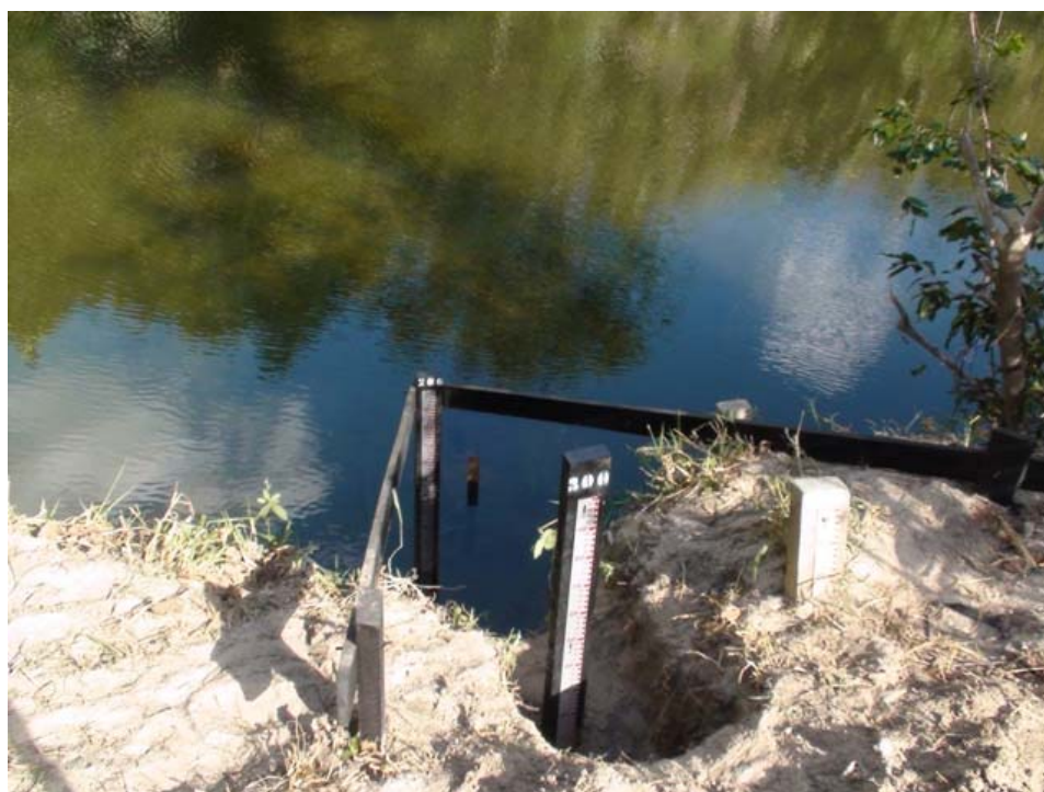
Foto 3 - Estação Fluviométrica/Telemétrica rio São Félix
