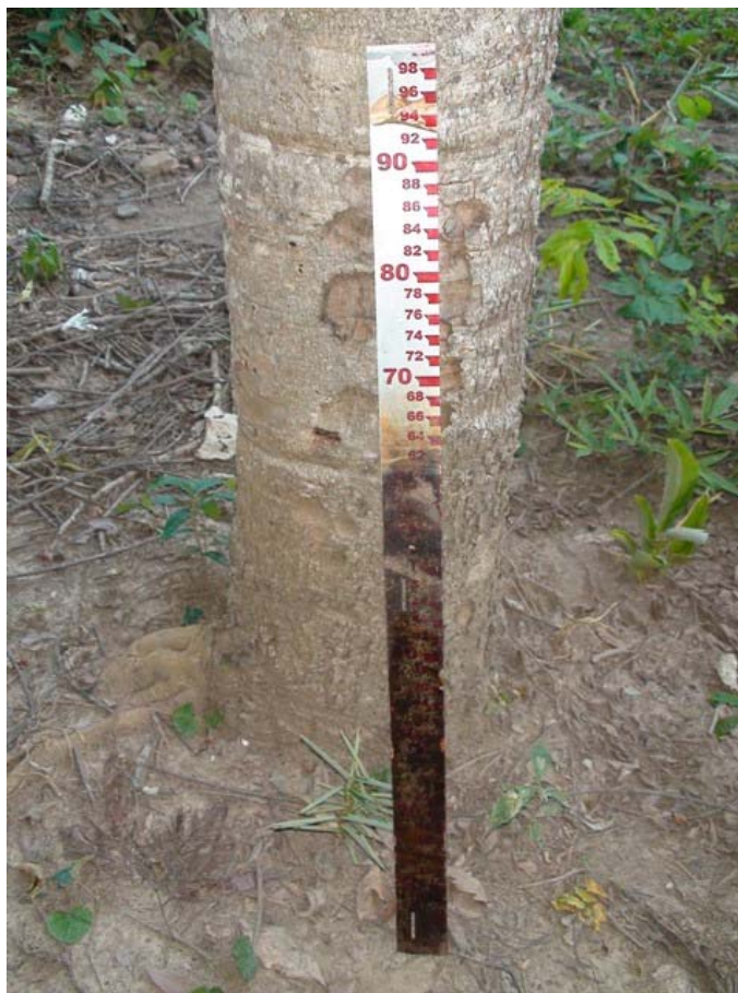
Foto 4 – Régua que sofreu oxidação, retirada da Estação Fluviométrica Rio Bonito
