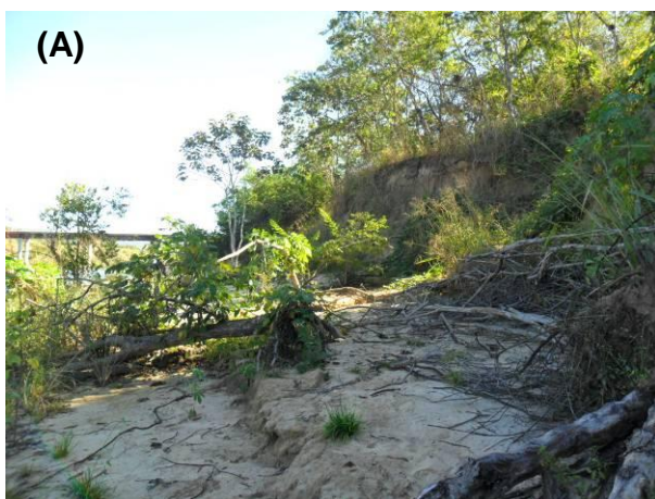
Foto 7.2.5-1 – Ponto JB1. (A) Depósito aluvionar na margem direita do rio Tocantins. Erosão por solapamento de base pelo embate de ondas do reservatório; (B) Talude com aproximadamente 7 metros de altura.
