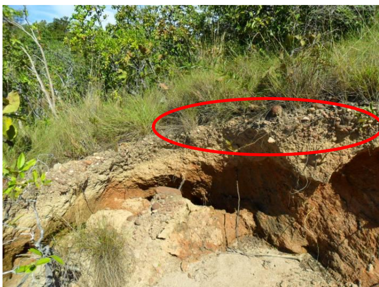
Foto 7.2.2-6 – Ponto SN4. Nota-se o depósito de seixos coluvionares na parte superior do terreno (destaque em vermelho), e logo abaixo o solo, com aproximadamente 1,5 metros de espessura.
