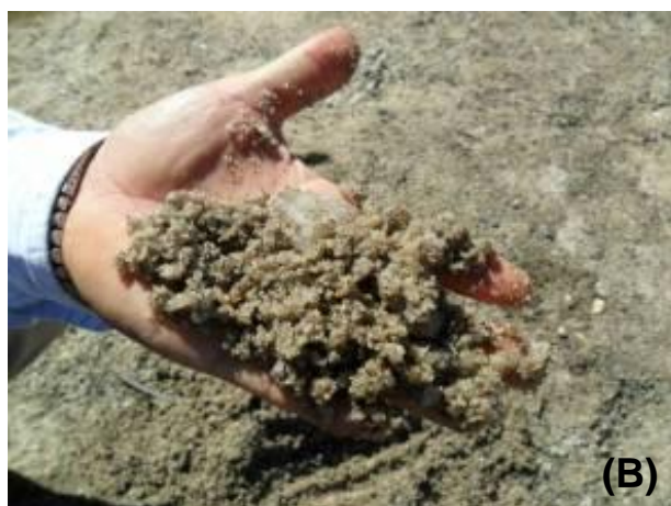
Foto 7.2.1-3 – Ponto SC6. (A) Vista do banco de areia formado pelos sedimentos vindos do rio dos Macacos que deságua no reservatório. (B) Nota-se para a granulometria grosseira da areia, mal selecionada e com presença de pequenos grânulos.
