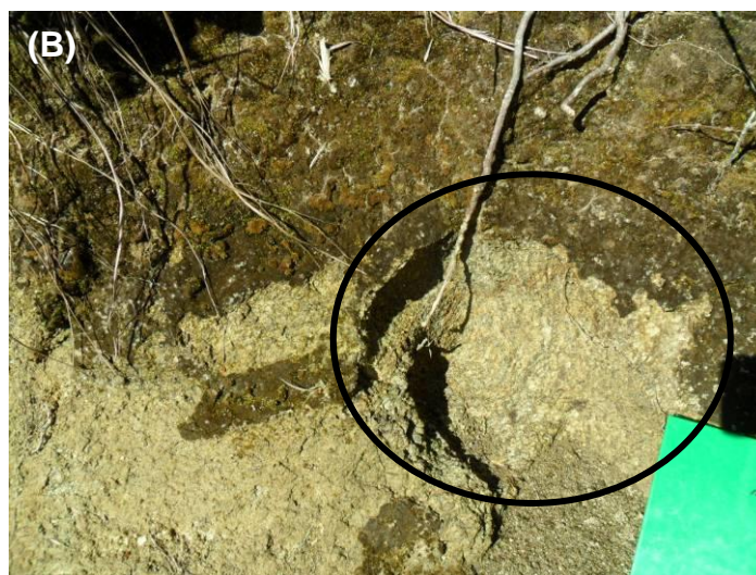
Foto 7.2.2-7 – Ponto SN5. (A) Detalhe do material coluvionar, e abaixo o solo proveniente da alteração do gnaiss com textura areno-siltosa; (B) Gnaiss (destaque em preto).
