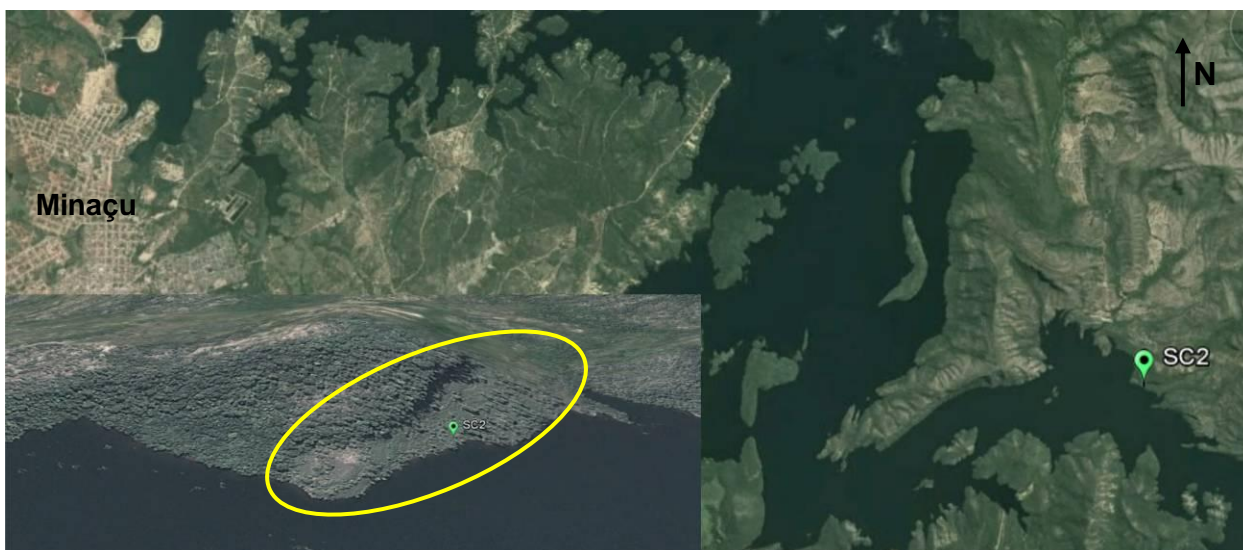
Figura 7.2.4-2 – Localização em maior detalhe do Ponto SC2, e no detalhe, em perspectiva. Este ponto está próximo a Serra da Bibiana, e apresenta um degrau de abatimento com possibilidade de escorregamento e/ou rastejo (Imagem Google Earth, 2013, sem escala).
