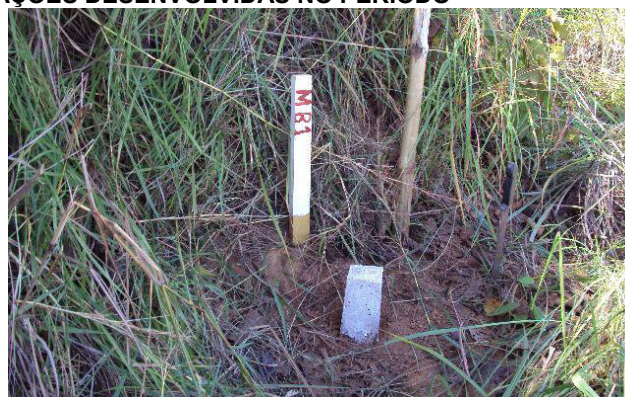
b) Ponto 15 – Marco de concreto para monitoramento.
