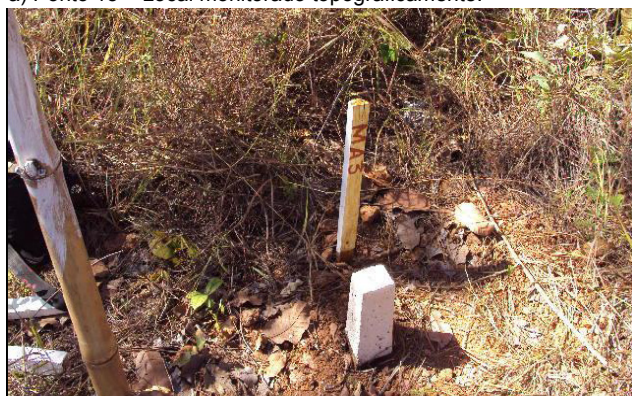
c) Ponto 15 – Marco de concreto para monitoramento.
