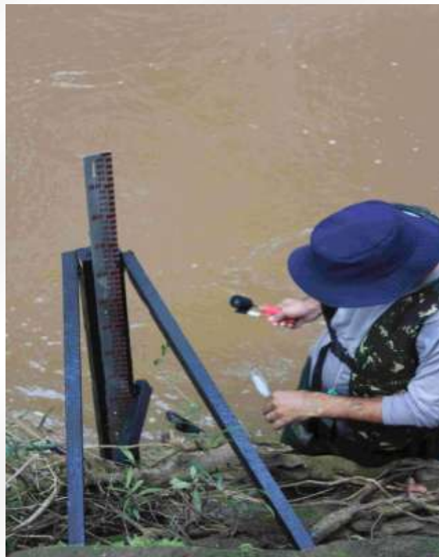
Instalação da Régua no Rio Bonito
