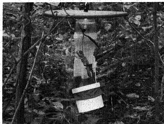
Figura 3. Armadilha luminosa CDC utilizada para coleta de insetos noturnos.
