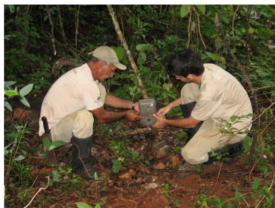
Figura 12. Instalação de uma armadilha fotográfica.
