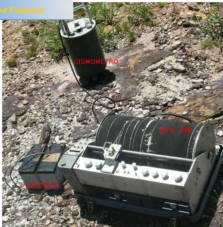
Figura 1 - Equipamentos utilizados nos testes de ruído sísmico.
