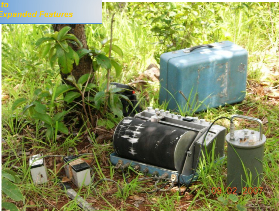
Figura 3 . Vista dos equipamentos em funcionamento durante o teste de ruído no Ponto 1.
