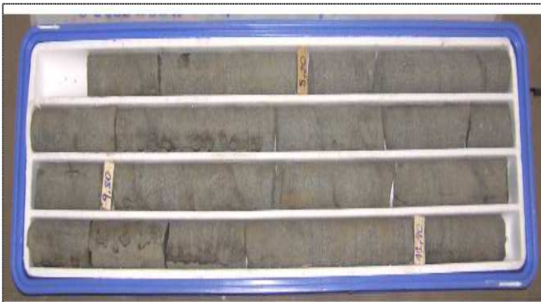
Figura 8.1-4 Núcleos de rocha diabásica recuperados na sondagem SR-303, localizada na pedreira
