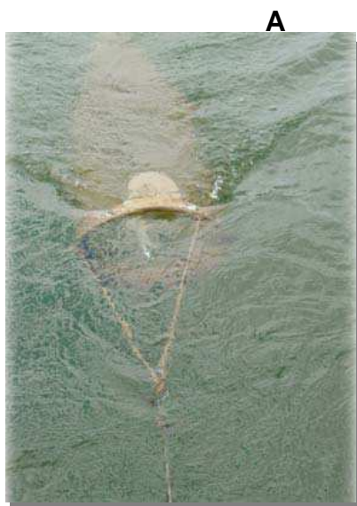
Foto 9.3.1-4. A. Rede cônico-cilíndrica empregada para a amostragem de ictioplâncton em coleta na superfície da água e B. rede acoplada ao amostrador de fundo, para coleta sobre o substrato.
