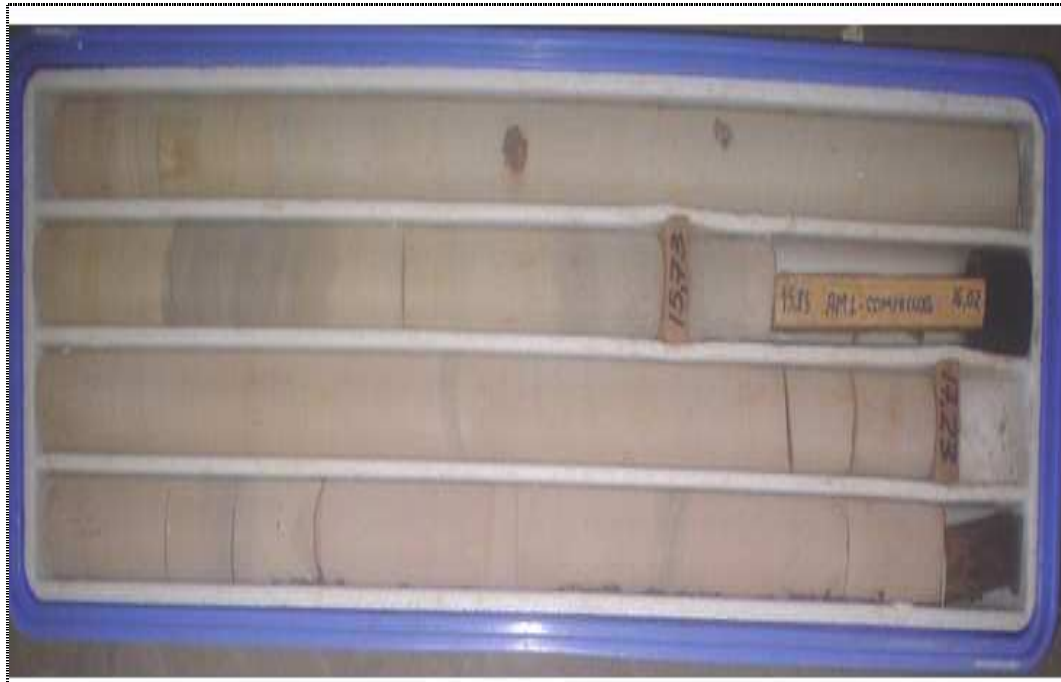
Figura 8.1-3 Recuperação de amostras na sondagem SM-302 – Ombreira direita
