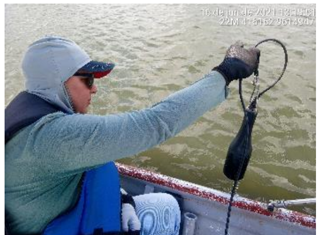
Figura 13 – Utilização de sonda multiparamétrica - Ponto RX 20 – Junho de 2021
