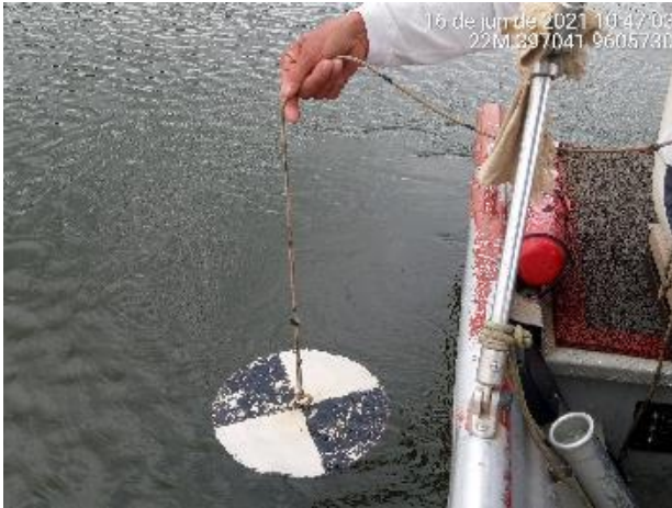
Figura 4 – Utilização do Disco de Secchi para avaliação da transparência no ponto FAZENDA – Junho de 2021
