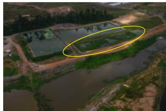
**Figura 3.1 - 41 – ETE e em destaque o Sistema de Pós - Tratamento (Wetland) - Canais.**
