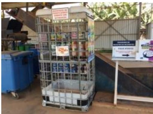
Figura 3.1 - 53 – Reaproveitamento de IBC para depósito de vasilhas com produtos químicos.
