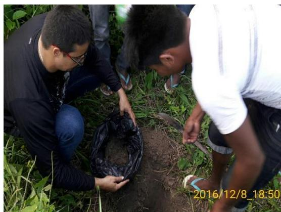
**Figura 8.3.3.4.3 – 27 - Coleta de amostra de solo para análise em laboratório.**
