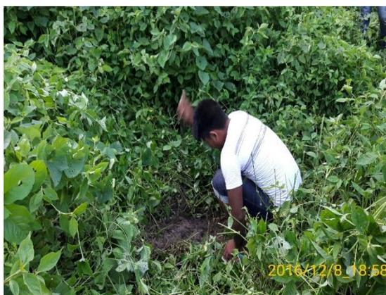
**Figura 8.3.3.4.3 - 26 - Coleta de amostra de solo para análise em laboratório.**
