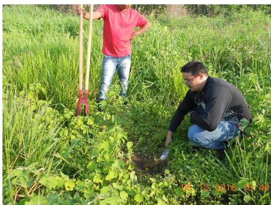
**Figura 8.3.3.4.3 – 19 - Coleta de amostra de solo para análise em laboratório.**
