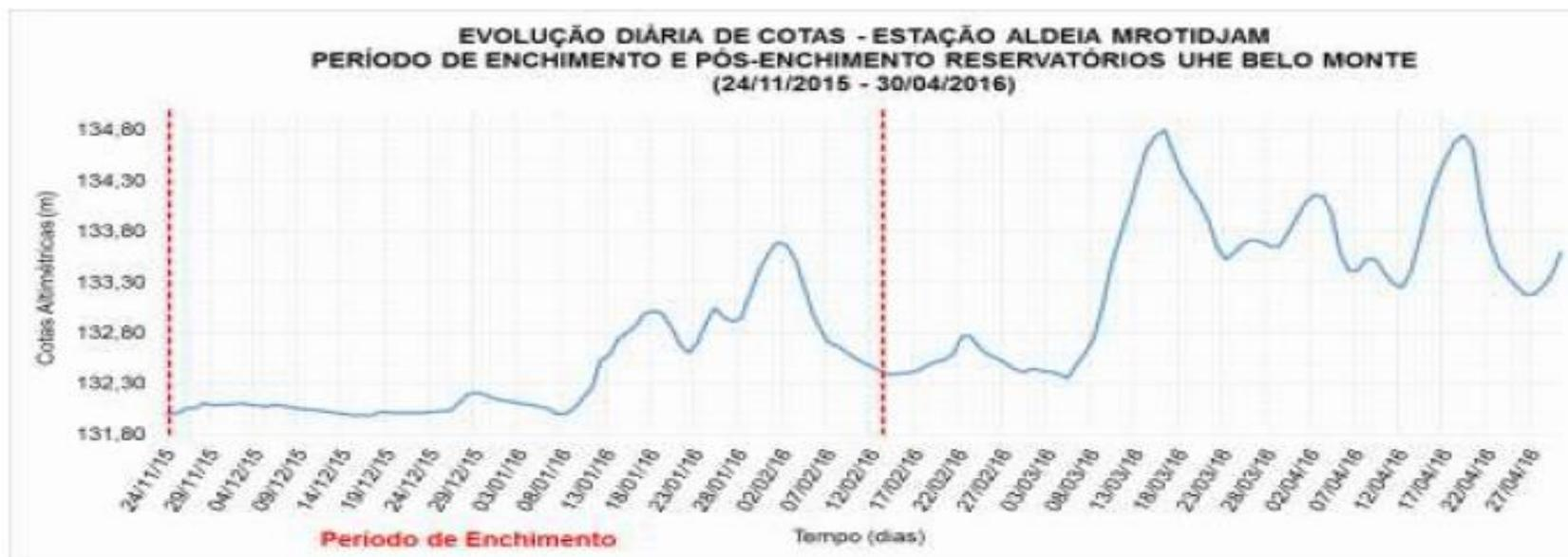
**Figura 11.1.2 - 7 – Evolução diária de cotas - Período (2) Enchimento e Pós-enchimento Reservatórios UHE Belo Monte - Estação Mrotidjã.**
