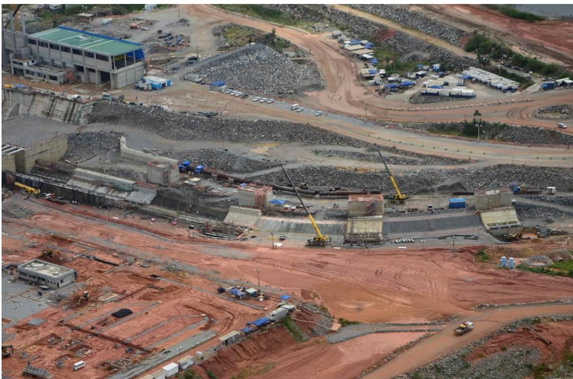
**Figura - 6 – Vista aérea do sistema de água de atração, composto por tomada d'água, conduto forçado e quatro dissipadores com difusores.**
