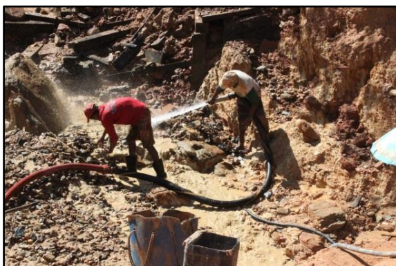
Figura 3 – Utilização de jato d'água, Garimpo do Itatá, Senador José Porfírio. Foto de Mariana Cavassana.
