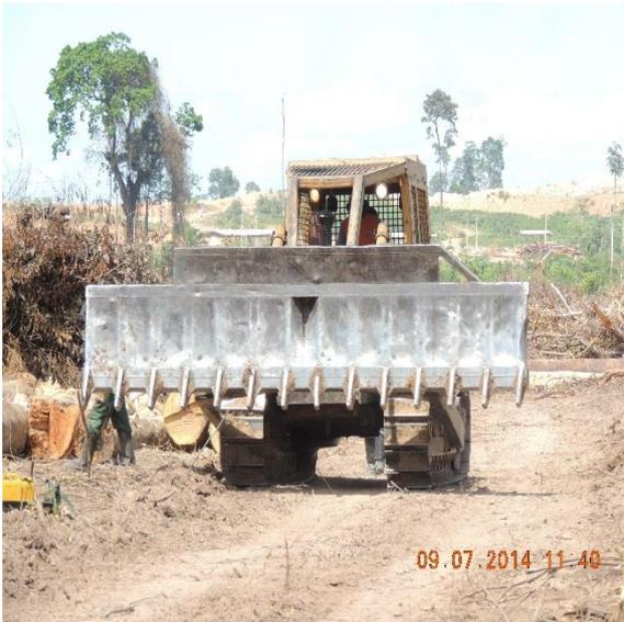
**Figura 12.1.1 - 18 – Trator de esteira utilizado no bosqueamento e enleiramento.**
