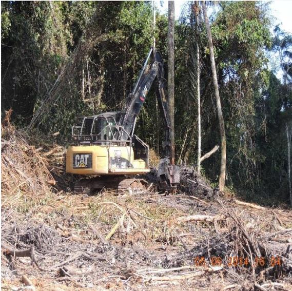
**Figura 12.1.1 - 32 – Corte com escavadeira hidráulica equipada com cabeçote de corte direcional.**
