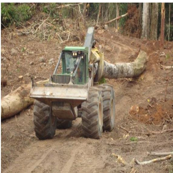
**Figura 12.1.1 - 40 – Arraste de toras para as esplanadas utilizando o skidder.**
