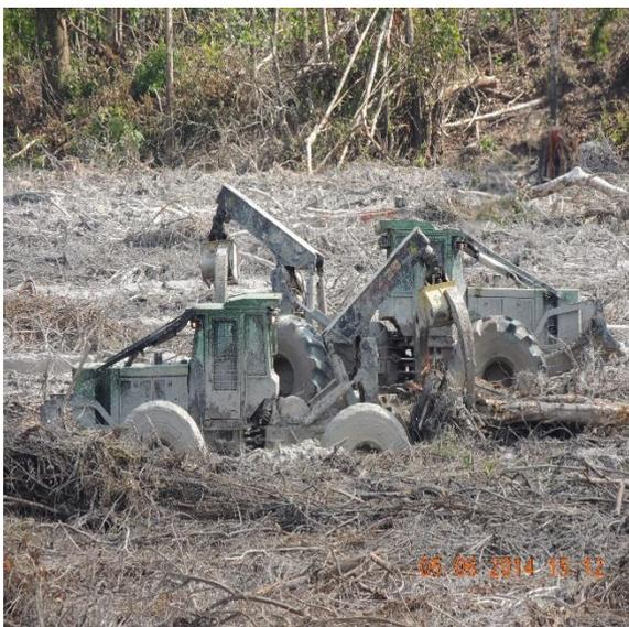
Figura 12.1.1 - 22 – Retirada do resíduo com uso de skidder em área alagada.
