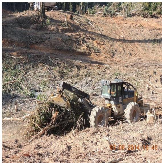
Figura 12.1.1 - 23 – Retirada do resíduo com uso de skidder.
