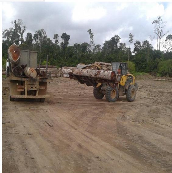
**Figura 12.1.1 - 45 – Descarregamento de toras romaneadas no pátio final utilizando carregadeira com garfo florestal.**
