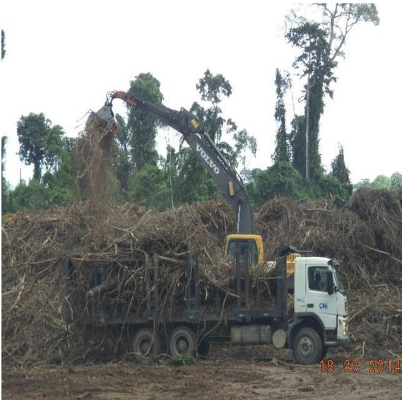
**Figura 12.1.1 - 26 – Descarregamento de resíduo fino no estoque de resíduo.**
