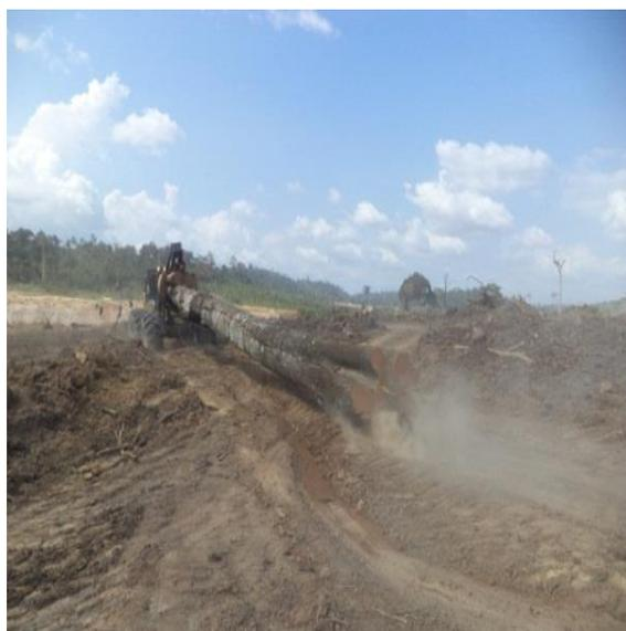
**Figura 12.1.1 - 41 – Arraste de toras com skidder para as esplanadas**
