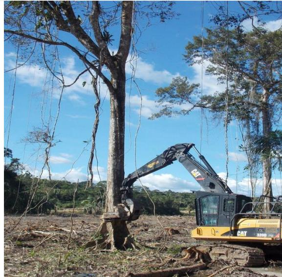
**Figura 12.1.1 - 33 – Corte com escavadeira hidráulica equipada com cabeçote de corte direcional.**
