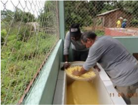
Figura 7.2 - 46 - Esfarelamento da Massa prensada. Em: 13.03.2015.
