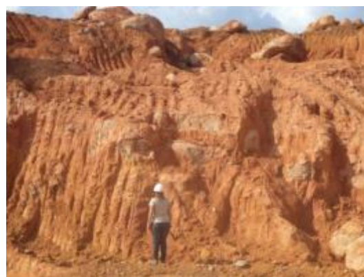
Figura 10.4 - 14 – Blocos de migmatito envolvidos por solo residual de textura argilo-arenosa próximos à barragem de Santo Antonio (Ponto 10)
