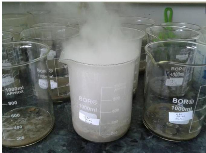
**Figura 9.3 - 50 - Desagregação química com peróxido de hidrogênio**
