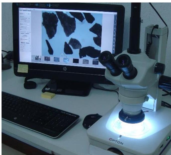
**Figura 9.3 - 53 - Triagem e identificação de microfósseis em microscópio estereoscópico de luz refletida com câmera digital acoplada**
