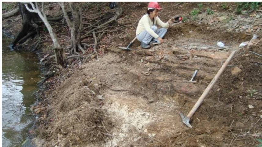
**Figura 9.3 - 14 - Camadas estreitas de arenitos friáveis na margem esquerda do rio Xingu, ponto C7P6**
