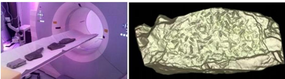
**Figura 9.3 - 9 - À esquerda a tomografia realizada em alguns fósseis; à direita um modelo tridimensional de bioturbações da amostra C2P4-7.2, em imagem 3D produzida pelo método**
