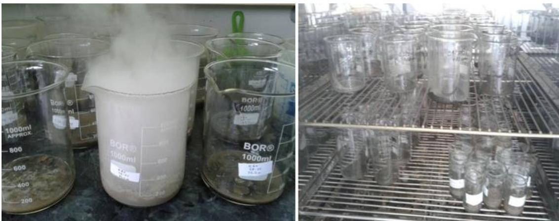
**Figura 9.3 - 10 - À esquerda, detalhe de reação forte do peróxido de hidrogênio com a matéria orgânica presente na rocha. À direita, frações das amostras em estufa a 70° C**
