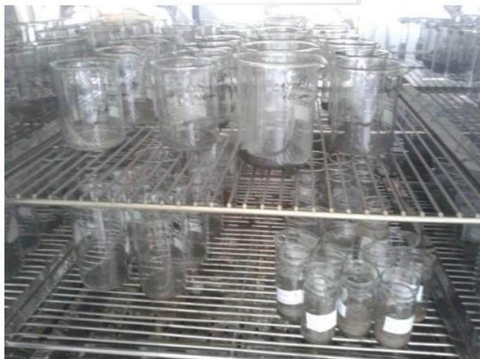
**Figura 9.3 - 52 - Secagem de frações em estufa a 70° C**
