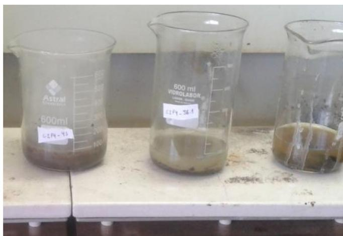
**Figura 9.3 - 51 - Uso de chapa aquecedora para intensificar a reação em amostras com baixa concentração de matéria orgânica**
