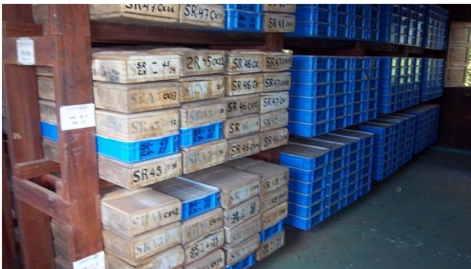
Figura 14 - Caixas com cilindros de sondagem depositadas na Subestação da Eletronorte em Altamira.
