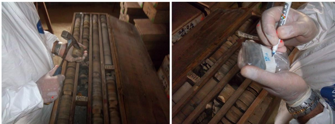
Figura 17 - Seleção e coleta de amostras dos cilindros de sondagem para preparação micropaleontológica.
