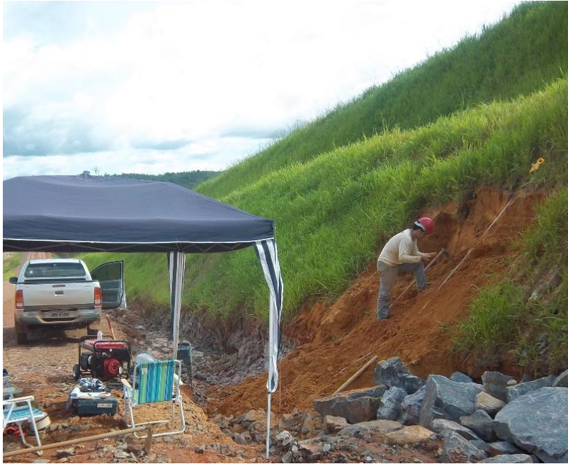
Figura 20 - Corte na margem oeste do Travessão 27. A coleta deu-se na vala de erosão (base da coluna) e no talude (topo da coluna).
