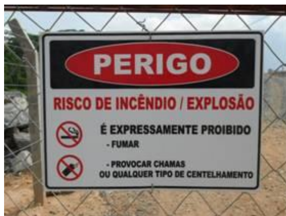
Figura - 4 – Sinalização de segurança do paiol de explosivos
