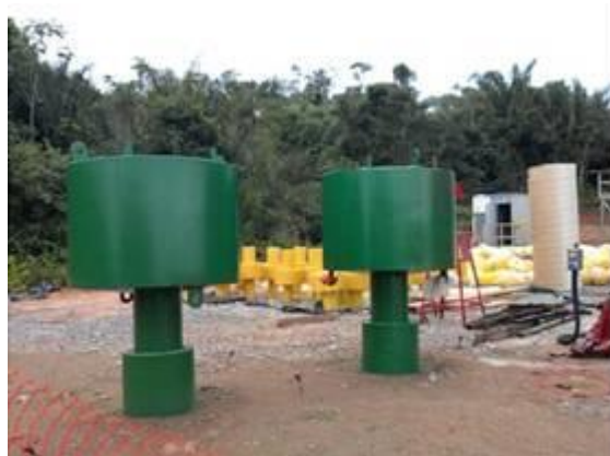
Figura - 8 – Detalhe das bóias pintadas nas cores verdes, encarnada e amarela para cordão de segurança
