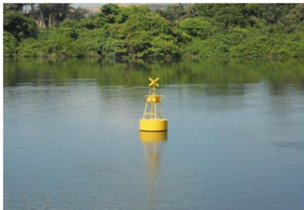
Figura - 2 – Sinalizador de Limitação da Área de Construção do Porto
