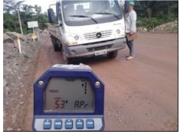
Figura - 8 – Medição da velocidade do veículo
