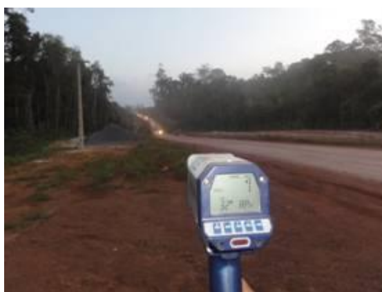
Figura - 6 – Medição da velocidade do veículo
