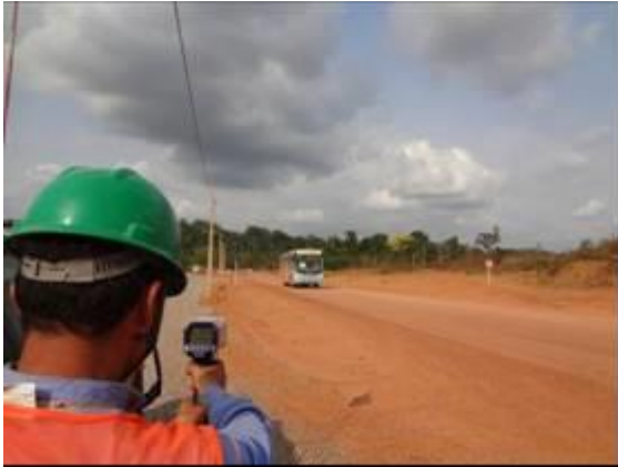
Figura - 9 – Medição da velocidade do veículo
