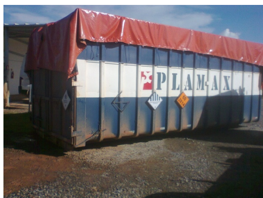
Figura - 11 – Retirada de resíduos contaminados por hidrocarbonetos pela Empresa Plamax
