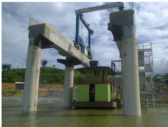
Figura 14.2.2 - 22 – Embarcação tipo Balsa com capacidade de carga para até 30 toneladas em teste no “Travel Lift” do STE – Subgrupo 4. Janeiro/2013
