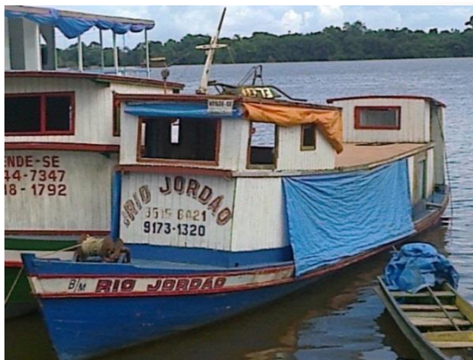
Figura 14.2.2 - 8 – Barco de Madeira, motor central, capacidade de carga de 4,0 toneladas – subgrupo 1.
