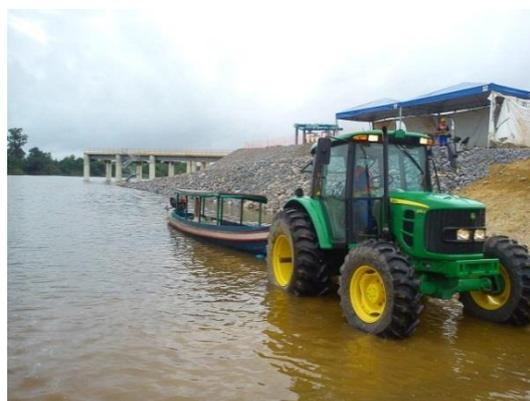
**Figura 14.2.1 - 2 – Sistema por trator e carretas de reboque em operação para transposição de embarcações com capacidade de carga inferior a 3,0 toneladas – fevereiro de 2013.**
