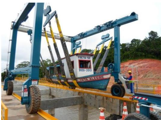
**Figura 14.2.1 - 1 – Sistema *Travel Lift* em operação para transposição de embarcações com capacidade de carga superior a 3,0 toneladas – fevereiro de 2013.**
