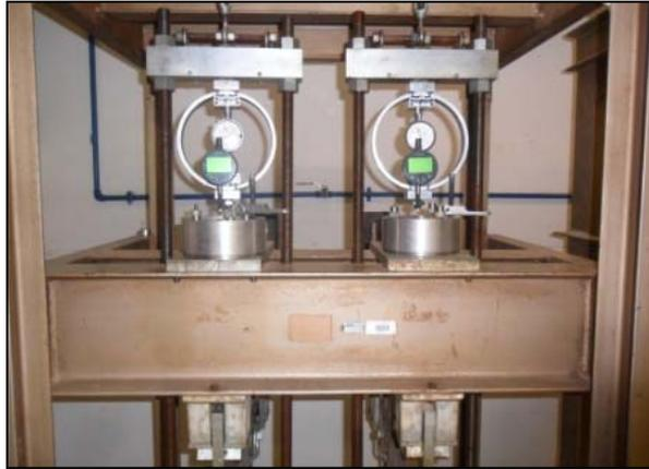
Figura 10.3-2 - Prensa usada no ensaio de adensamento.
