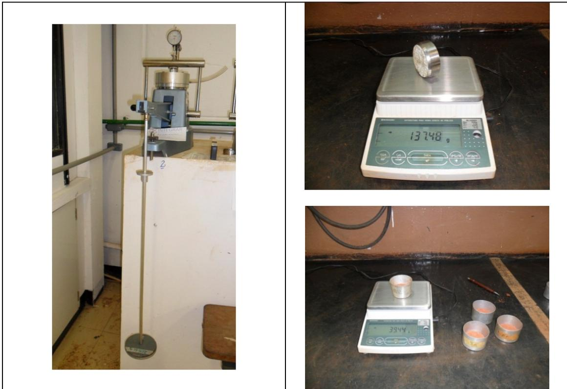
**Figura 10.3-1 - Equipamentos utilizados no ensaio de expansão unidimensional.**
