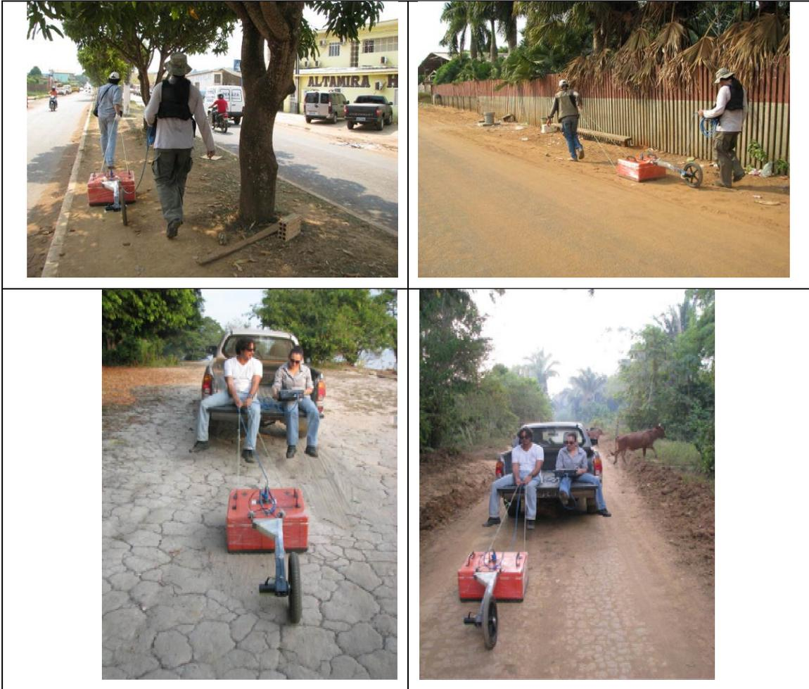
**Figura 10.3-5 - Fotografias ilustram a aquisição de dados de GPR ao longo da área urbana de Altamira/PA.**
