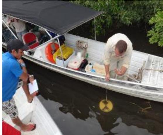
**Figura 14.4 - 8. Medição da transparência da água com o Disco de Secchi.**
