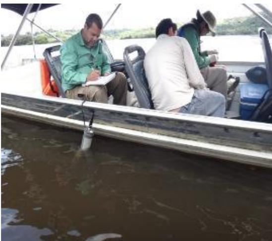
**Figura 14.4 - 11. Coleta de dados com Sonda multiparamétrica.**
