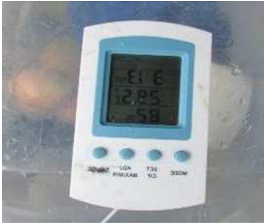
Figura 13: Aparelho medidor das condições do ar.
