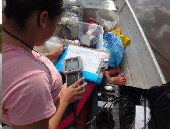
Figura 2: Sonda utilizada para medir a temperatura, condutividade e oxigênio da água.
