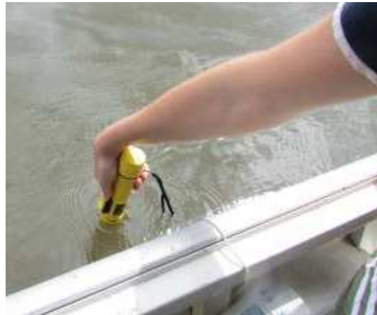
Figura 14: Profundímetro – aparelho utilizado para medir a profundidade do local.
