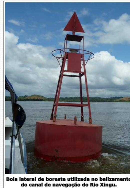
**Boia lateral de boreste utilizada no balizamento do canal de navegação do Rio Xingu.**
